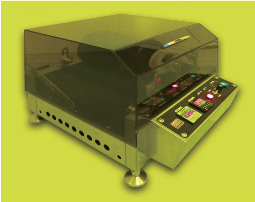
本機は自在な回転制御及び多機能デジタルタイマーの採用及び小型PLCを搭載し、組成・特性に合わせた緻密な回転が設定出来ます。
